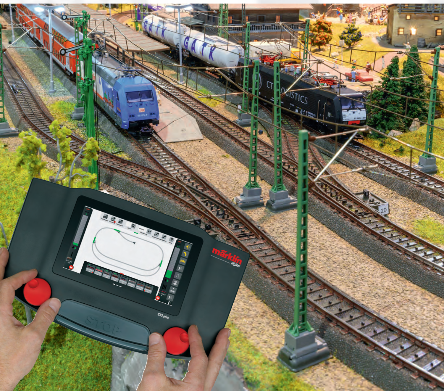
De Central Station 3 kan overweg met alle generaties digitale decoders die Märklin in de voorbije 30 jaar op de markt heeft gebracht.
